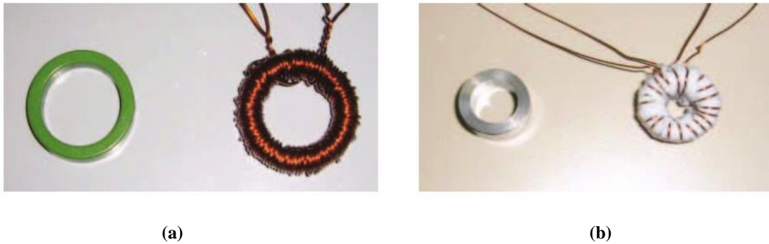
Figure I. 46 : Circuit torique adapté aux températures élevées, (a) après bobinage par fil de cuivre haute température, (b) après isolation par un ruban en fibre de verre.[8]
