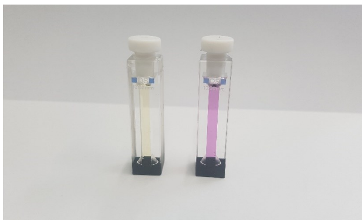
Figure 49 : Sonde cyanine diluée à 50 \mu\text{M} dans une solution tampon Britton Robinson à \text{pH}=2,5 à gauche et à \text{pH}=10 à droite.
