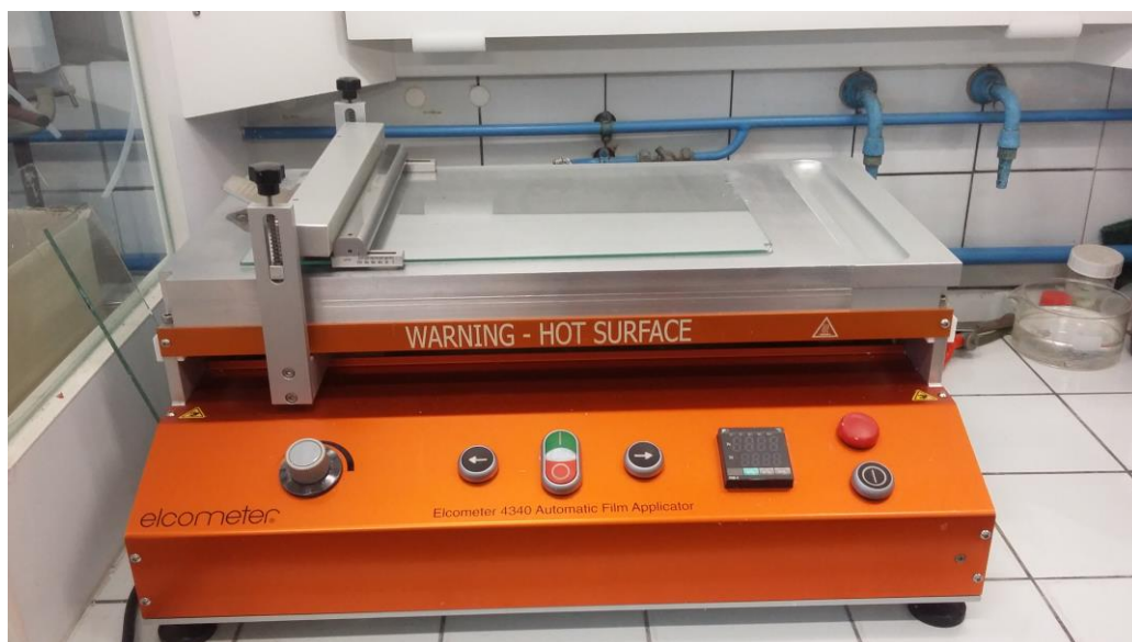
Figure 2-3 : Photo de la casting machine équipée du verre plat
