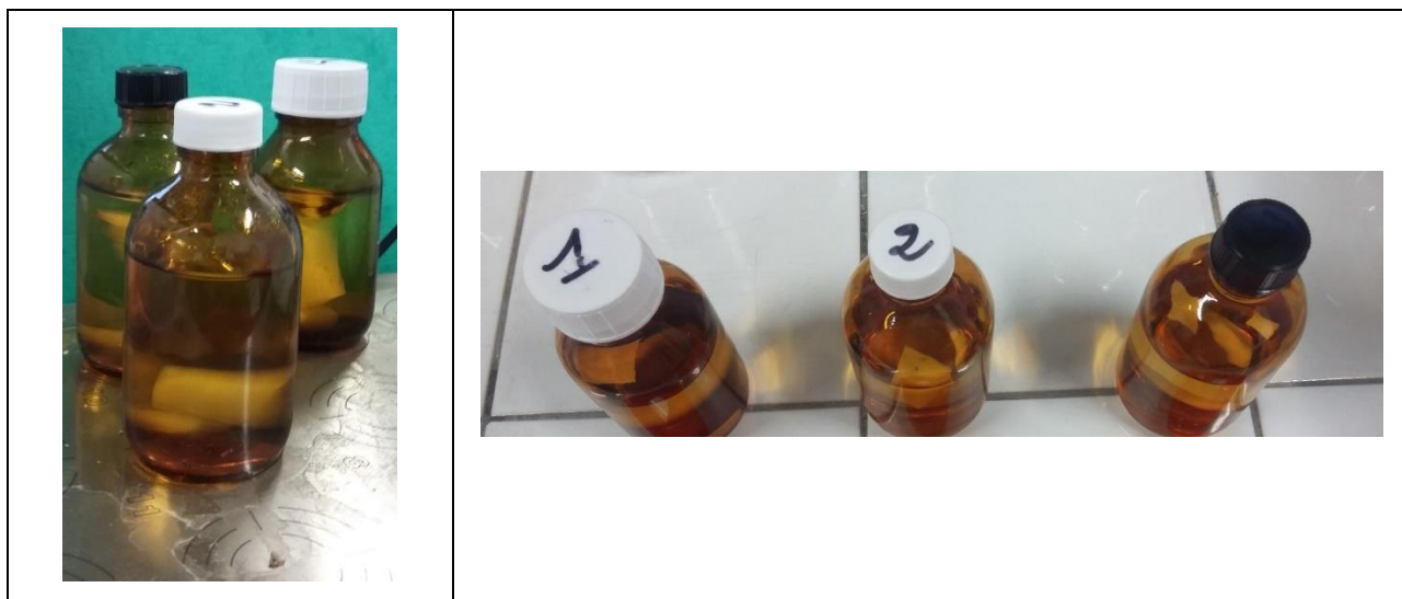
Figure 2-4 : coupons de membrane dans une bouteille brune de 30 ml sur la plaque d'agitation.
