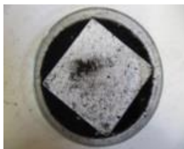
Figure 41 : Observation d'une cible déposée au sol après incendie
