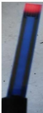
Figure 80 : Illustration photographique du capteur lors de la phase de régénération (la face sensible du capteur apparaît ici en rouge car portée à une température de 650°C)
