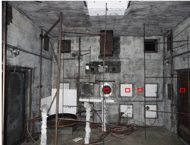
Figure 36 : Différentes surfaces de dépôt (de gauche à droite : verre, isolant, béton, métal)
