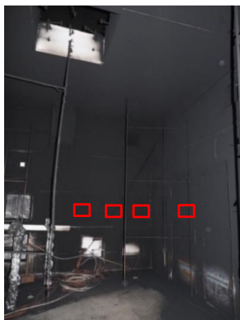
Figure 40 : Dépôt sur les surfaces représentées sur la figure 36 (de gauche à droite : verre, isolant, béton, métal)
