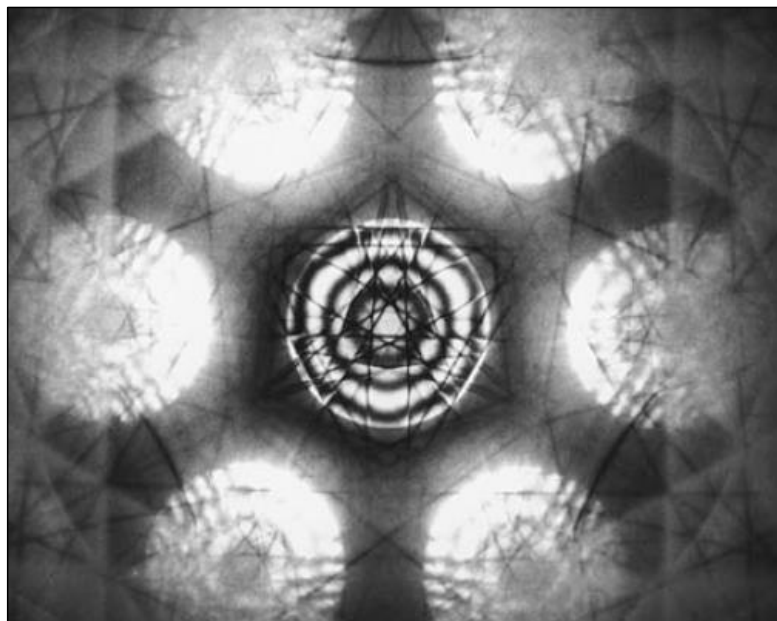
FIGURE 1.4 – Cliché de diffraction CBED obtenu sur du Si [111]. Image reproduite à partir de "Transmission electron microscopy : a textbook for materials science", par Carter, C. B., & Williams, D. B. (2011).
