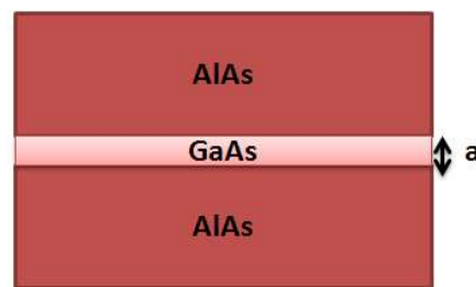
FIGURE 1.5 – Coupe schématique d'un puits quantique de GaAs intercalé entre deux couches de AlAs.
