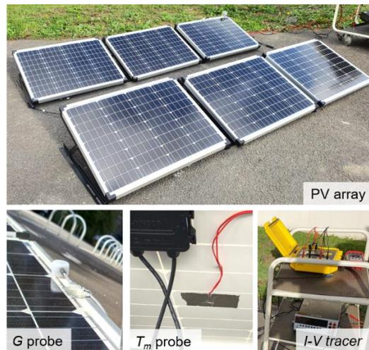
Figure 4: Configuration des tests sur le terrain
