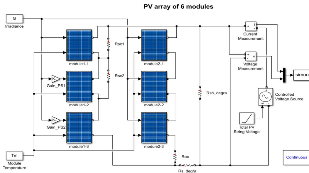
Figure 1: Modèle de simulation pour l'installation PV
