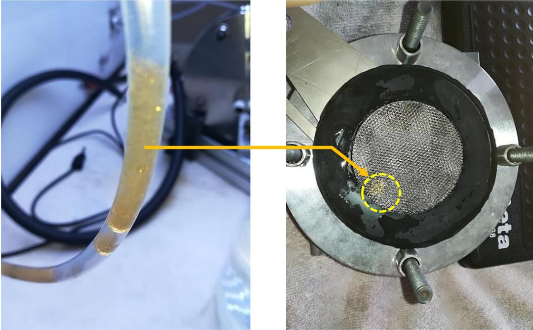
Figure 64: Billes désionisantes ayant pollué le circuit d'alimentation en eau de la PEMWE (Billes dans l'alimentation en entrée de la PEMWE à la cathode à gauche, billes obstruant la grille de la PEMWE à droite)
