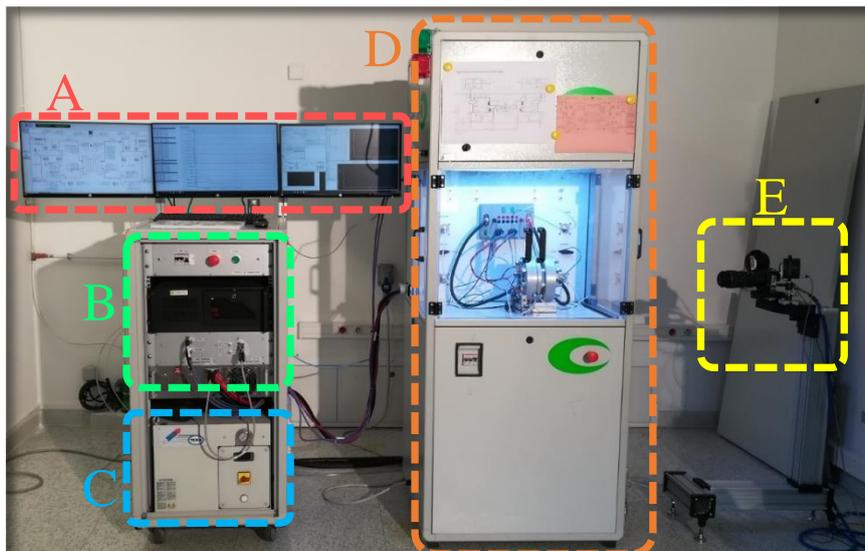
Figure 99: Banc d'essai pour PEMWE (Laboratoire EnergyLab/LE<sup>2</sup>P)
