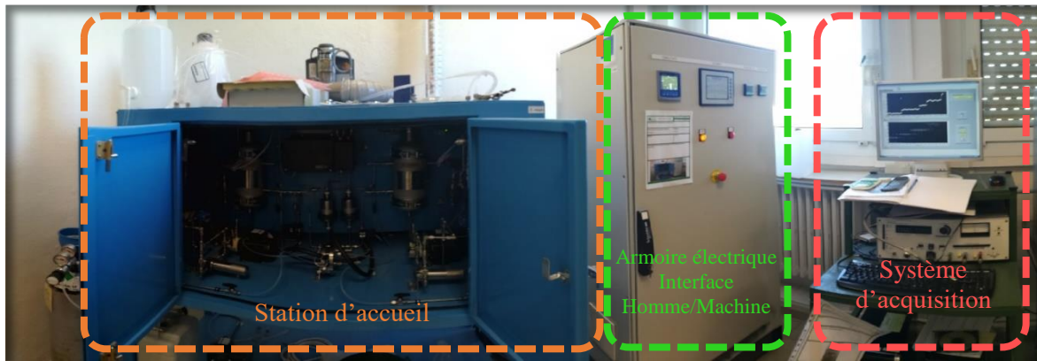
Figure 76: Photo du banc de test pour cellule d'électrolyse à membrane échangeuse de protons, situé à l'IC2MP (Poitiers)
