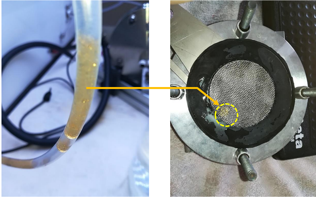
Figure 64: Billes désionisantes ayant pollué le circuit d'alimentation en eau de la PEMWE (Billes dans l'alimentation en entrée de la PEMWE à la cathode à gauche, billes obstruant la grille de la PEMWE à droite)
