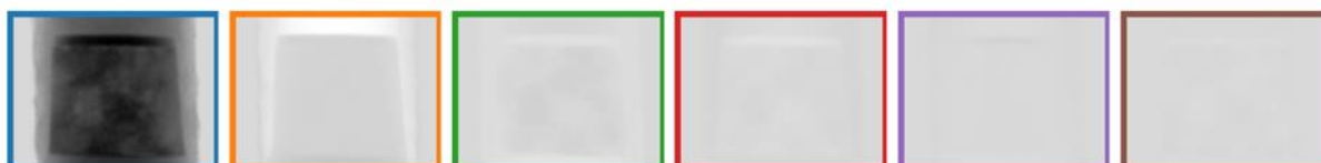
Figure 2-12 : Résultat de la décomposition par PCA de l'image STEM-EELS. Les 6 premières composantes sont présentées ainsi que leurs poids dans l'image hyperspectrale. L'échelle d'intensité est la même pour toutes les images.
