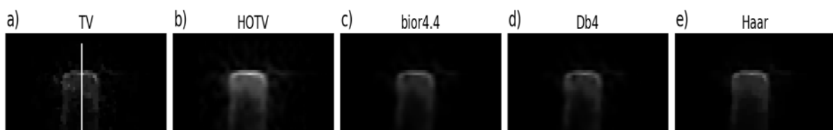
Figure 5-11 : Coupes à travers le volume reconstruit à partir de la composante d'arsenic extraite par VCA sur les données EELS pour différents termes de parcimonie, le trait blanc sur la première coupe donne l'emplacement utilisé pour tracer les profils présentés en figure 5-12.
