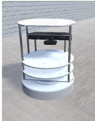
Figure 6.3 – Modèle de simulation du robot TurtleBot2
