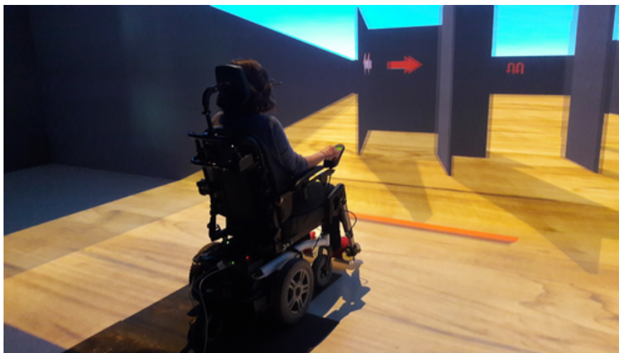
Figure 2.7 – Utilisation d’un CAVE pour l’immersion en réalité virtuelle d’un utilisateur de fauteuil roulant à assistance anti-collision
