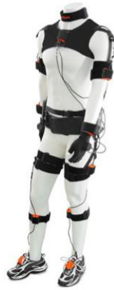
Figure 7.4 – Le costume Xsens permettant la capture des mouvements du corps avec ses 18 capteurs IMU.
