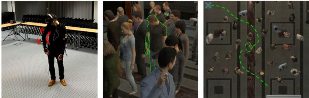
Figure 8.1 – Notre objectif est de comprendre si et dans quelle mesure le fait de fournir un rendu haptique des collisions lors de la navigation dans une foule virtuelle (à droite) permet aux utilisateurs de se comporter de manière plus réaliste. Chaque fois qu’une collision se produit (au centre), les brassards portés sur les bras vibrent localement pour rendre compte de ce contact (à gauche). Nous avons réalisé une expérience avec 23 participants, et utilisé des mesures subjectives et objectives relatives à la planification de la trajectoire des utilisateurs, les mouvements du corps, l’énergie cinétique, la présence et l’incarnation.
