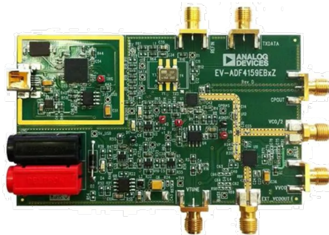
FIGURE 3.27 : Carte Analog Device ADF4159EB utilisée pour générer un signal FMCW
