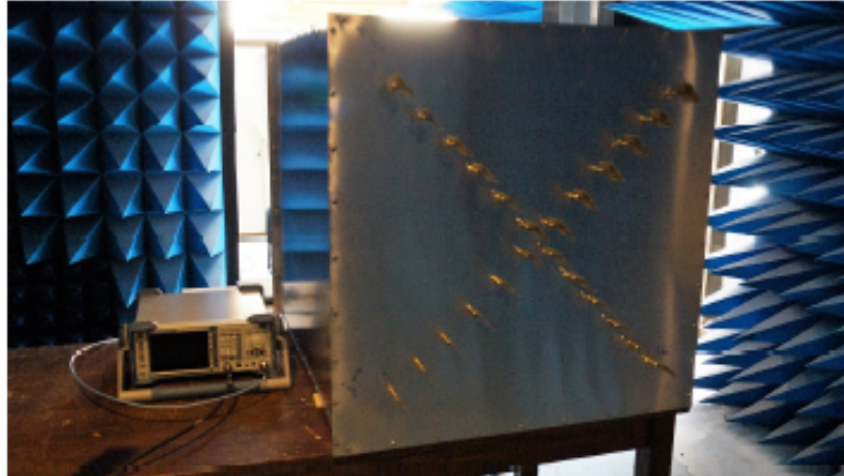
FIGURE 1.20 : Systèmes développés par T.Fromenteze et al. [89]. On y voit la cavité chaotique connectée à 24 antennes.
