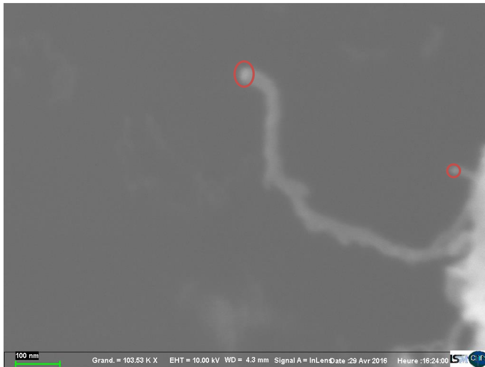
Figure 2.16. Nanoparticule de forme sphérique suspendue au sommet d'un nanotube sur un substrat \text{SiN}_2 à 650\text{ }^\circ\text{C} . (Echelle 100 nm)
