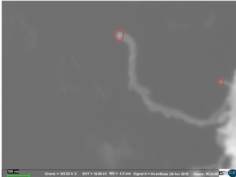
Figure 2.16. Nanoparticule de forme sphérique suspendue au sommet d'un nanotube sur un substrat SiN 2 à 650 °C. (Echelle 100 nm)
