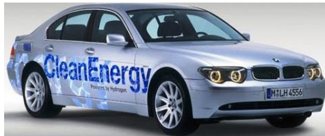
Figure A.1: La voiture « Hydrogen 7 » de BMW propulsée par la combustion de l'hydrogène [14].
