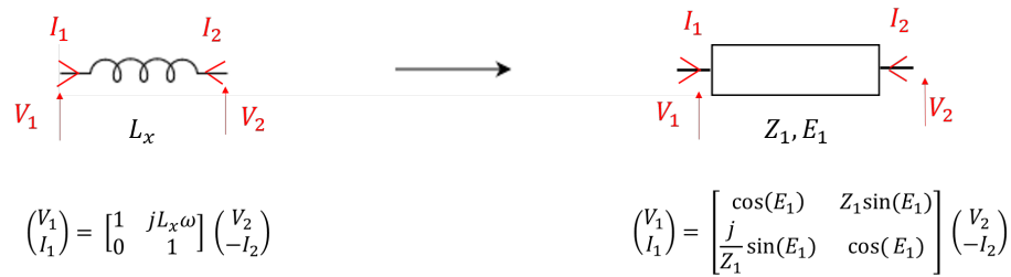
FIGURE III.14 – Matrices chaînes associées à une self série et à une ligne de transmission série sans pertes
