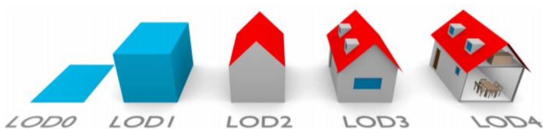
Figure V-1 : Les 5 LOD du langage CityGML, (Biljecki & Ledoux, 2016)
