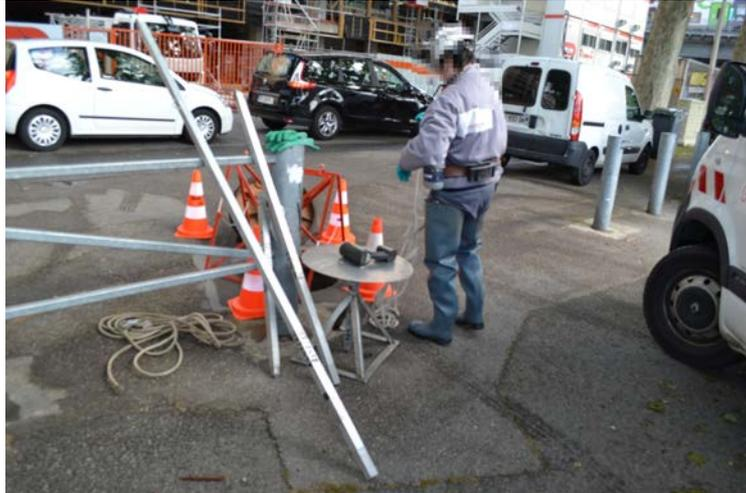
Matériels nécessaire à la vérification des sondes : piges (ou cales) et plateau sur trépied pour la vérification des sondes ultrasonores (mesure du niveau d'eau) ; radar (posé sur le plateau) pour la vérification de la sonde Doppler (mesure de la vitesse de l'écoulement).
