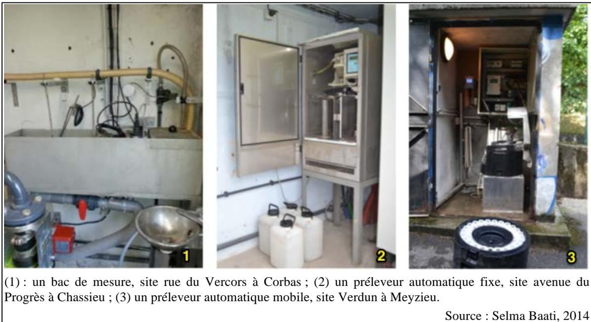
**Figure 22 : Exemples de stations de mesure – Métropole de Lyon**
