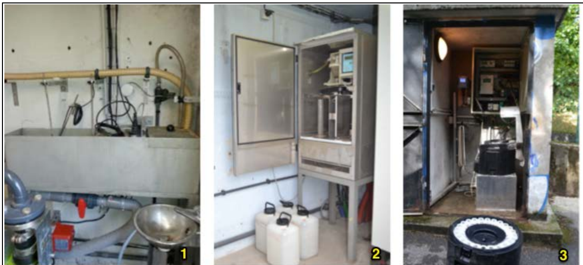
(1) : un bac de mesure, site rue du Vercors à Corbas ; (2) un préleveur automatique fixe, site avenue du Progrès à Chassieu ; (3) un préleveur automatique mobile, site Verdun à Meyzieu.
