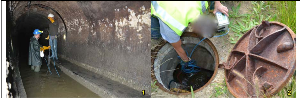
Exploration du champ de vitesse avec un courantomètre.
