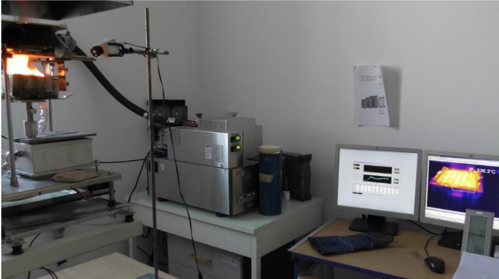
Fig. 34 : Mesure par la caméra infrarouge lors d'un essai au cône calorimètre.
