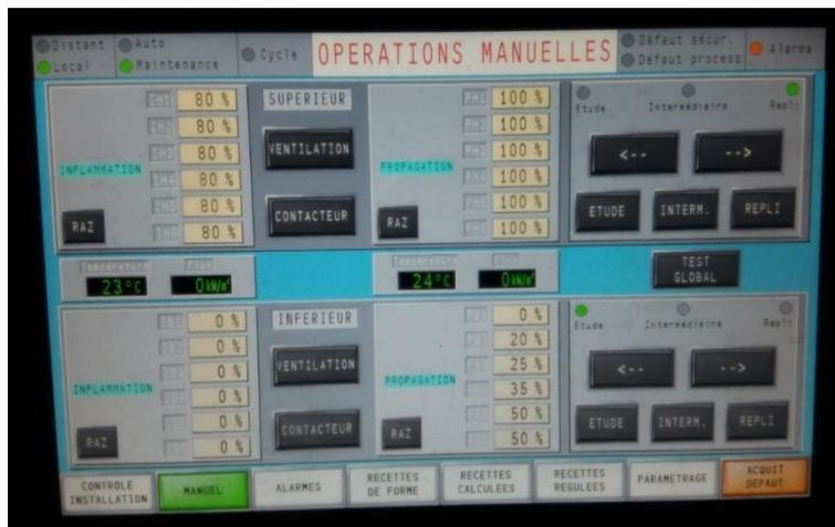
Fig. 79 : Exemple d'écran de l'interface homme/machine permettant de piloter le dispositif CISCCO.
