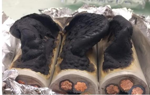
*Fig. 52 : Char intumescent se formant sur le câble PVC Blanc avant l'inflammation.*
