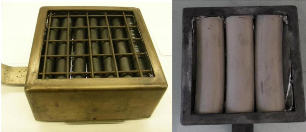
*Fig. 33 : Disposition d'un échantillon de câble selon la norme ISO 5660 (gauche) et la configuration étudiée dans le cadre de cette thèse (droite).*
