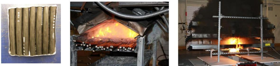
*Fig. 3 : Essais à petite (gauche), moyenne (milieu) et grande (droite) échelle réalisés lors du programme CHRISTIFIRE [5].*
