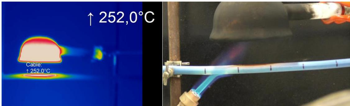
Fig. 65 : Observation par caméra IR (gauche) et caméra classique (droite) de la propagation horizontale avec préchauffage par épiradiateur.
