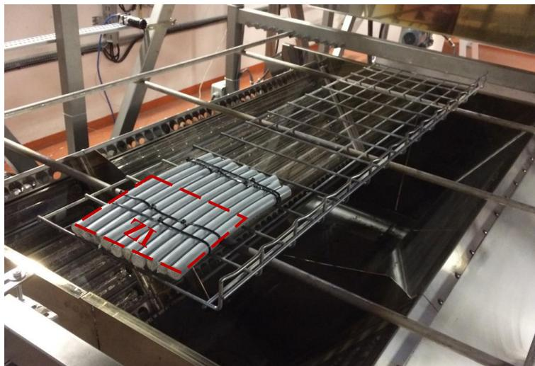
Fig. 108 : Nappe de câbles ( $20 \times 35$  cm<sup>2</sup>) pour les essais préliminaires d'inflammation dans le dispositif CISCCO avec les panneaux rayonnants inférieurs dans la zone d'essais.
