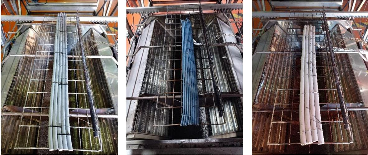
Fig. 134 : Chemins contenant des câbles PE Gris (photo de gauche), PE Bleu (photo du milieu) et PVC Blanc (droite) utilisés lors de la seconde campagne expérimentale.
