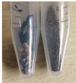
Fig. 60 : Char sous forme extraite du câble (gauche) et en poudre (droite).
