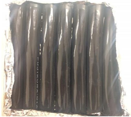
Fig. 53 : Aspect du câble PVC Noir 10s avant l'inflammation.
