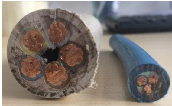
*Fig. 46 : Câbles PVC Blanc (gauche) et PE Bleu 1 (droite).*
