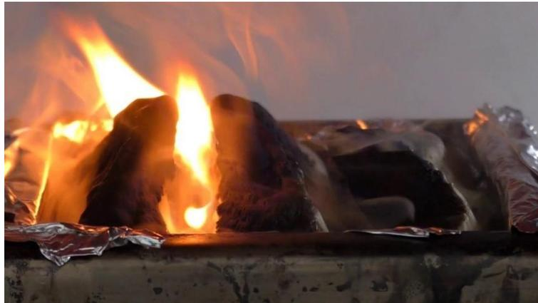
*Fig. 44 : Photographie à l'inflammation du câble PVC Blanc exposé à un flux de 25 kW/m<sup>2</sup> et qui présente un développement important de char intumescent.*
