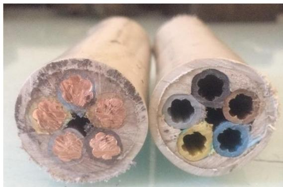
*Fig. 47 : Câble PVC Blanc avec (gauche) et sans (droite) cuivre.*
