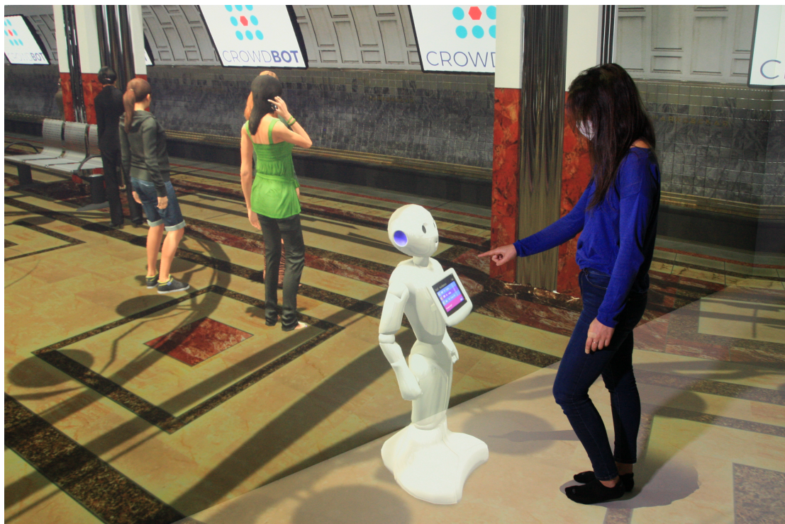
Figure 7.1 – Illustration d'interaction humain-robot virtuelle. Le robot Pepper est virtuel alors que la personne est dans un CAVE ("Cave Automatic Virtual Environment"), un outil d'immersion en réalité virtuelle
