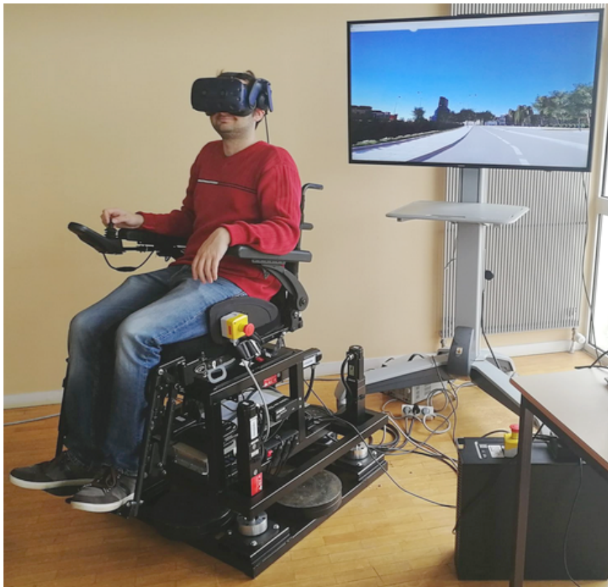
Figure 9.1 – Le simulateur de fauteuil roulant électrique PWS (pour " Power Wheelchair Simulator ") : plateforme mécanique et scène 3D transmise à travers un HMD pour une expérience immersive dans la Ville de Rennes.
