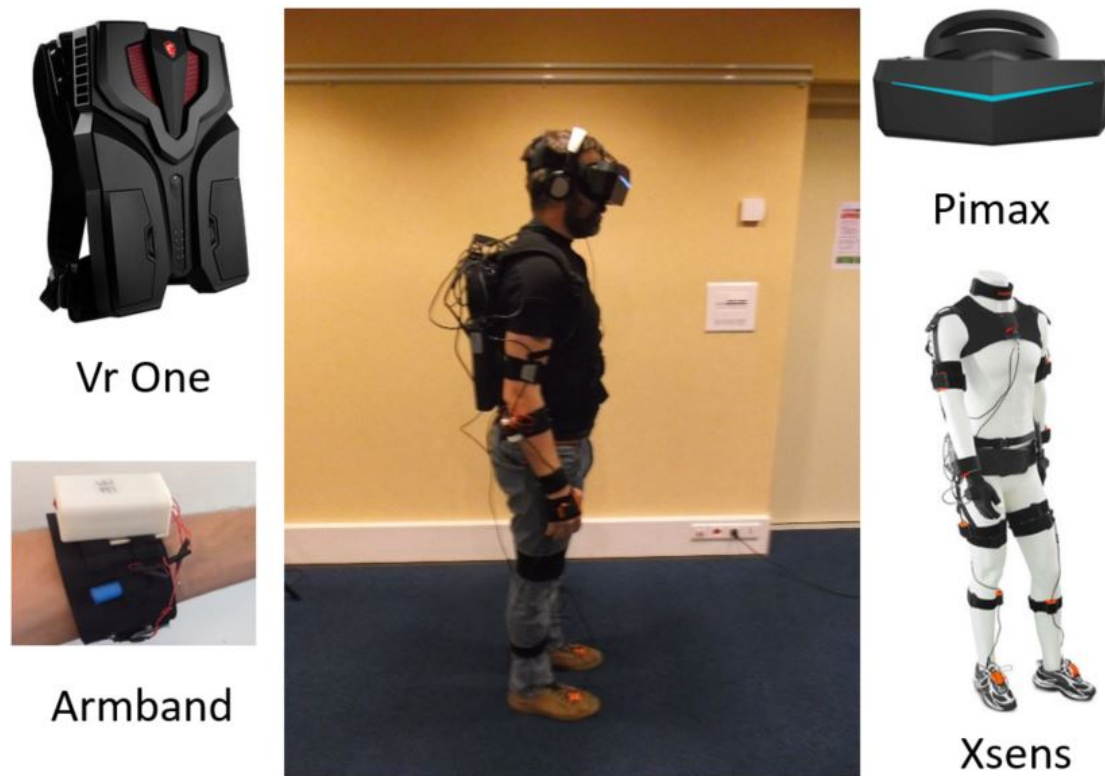
Figure 8.2 – Dispositifs portés par les participants pendant l'expérience.
