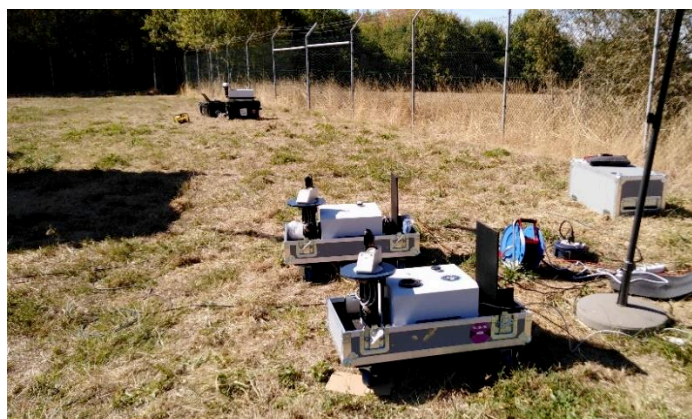
Figure 5.7: L'exercice d'inter-comparaison réalisé à Trainou avec les EM27/SUN (droite), CHRIS (gauche) et l'IFS125HR du TCCON.
