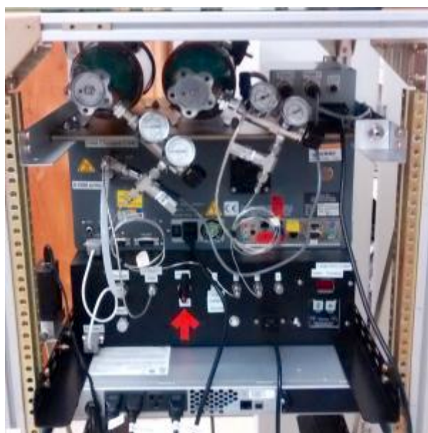
Figure 1.15: Une vue globale de l'analyseur G2401m utilisé pour la mesure du dioxyde de carbone, le méthane, le monoxyde de carbone et la vapeur d'eau (Source : NASA/airborne science).
