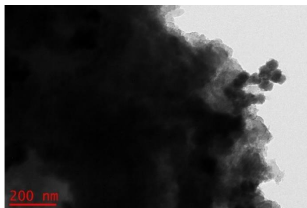
Figure 90 : Images TEM d'une résine phytochimique contenant 10 % de Pd. 262
