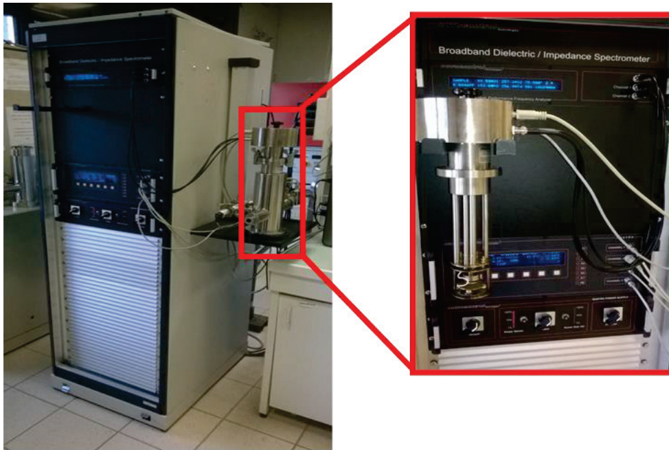
Figure 3-15. Photos de l'appareil de Spectroscopie Diélectrique à Large Bande. A gauche : Photo générale de l'appareil de mesure diélectrique. A droite : Photo du support, où la nanomembrane est déposée entre deux électrodes.
