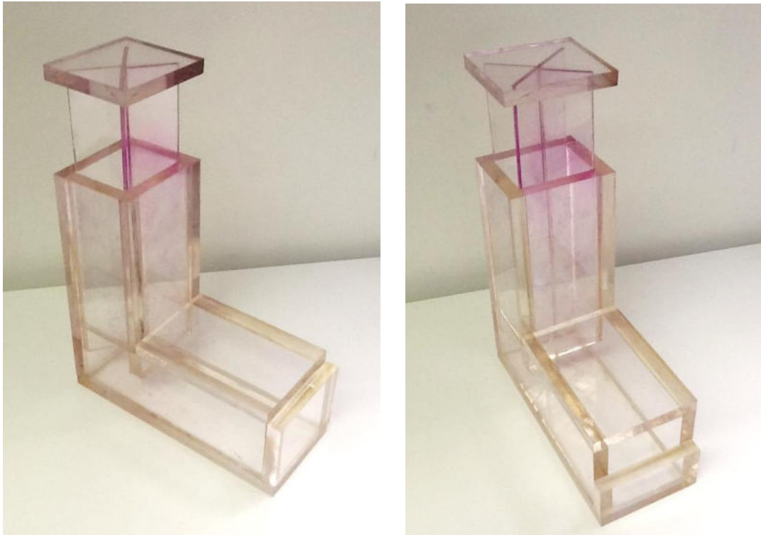
Figures 168 : Maquette d'essai en soufflerie, échelle 1/50
