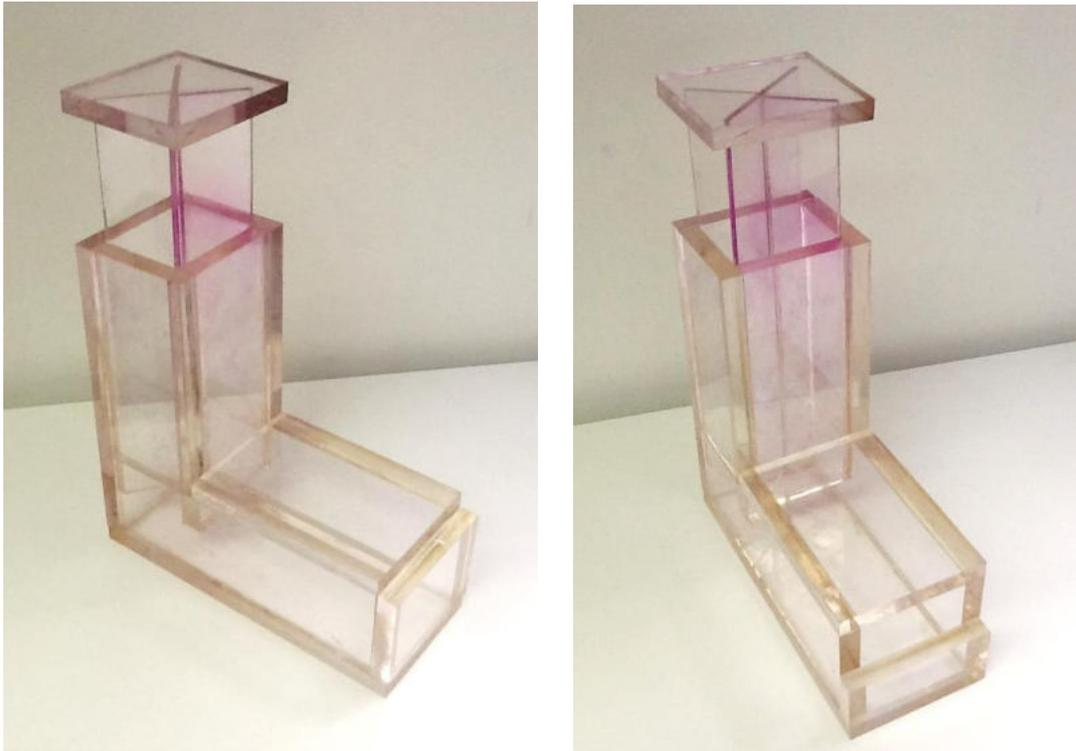
Figures 168 : Maquette d'essai en soufflerie, échelle 1/50
