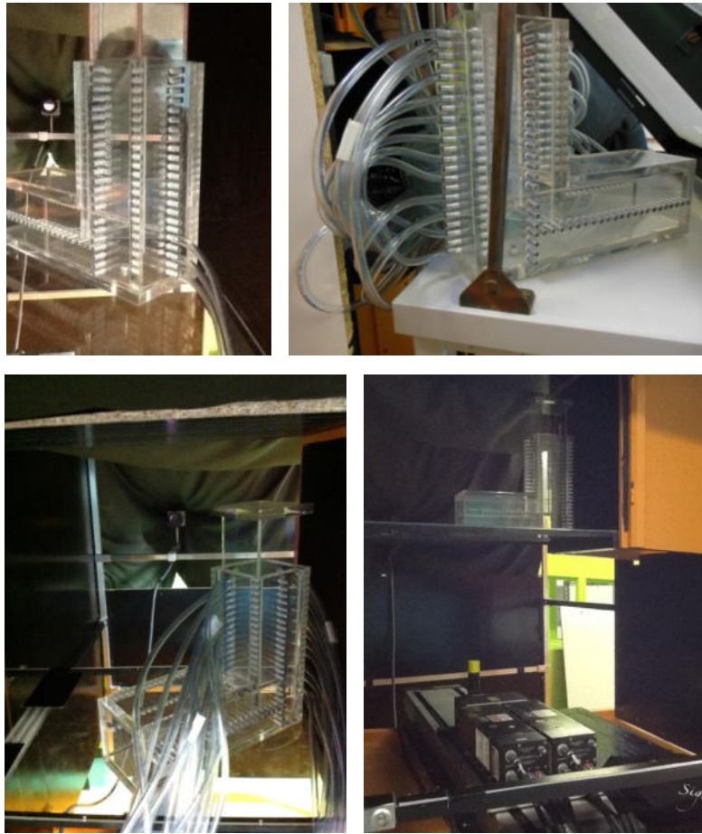
Figure 185 : Maquette installée dans la soufflerie
