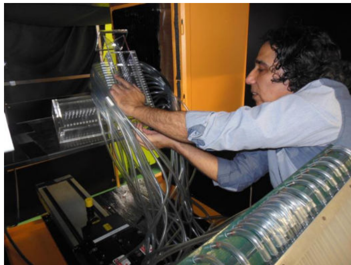
Figure 213 : Installation de la maquette à la soufflerie
