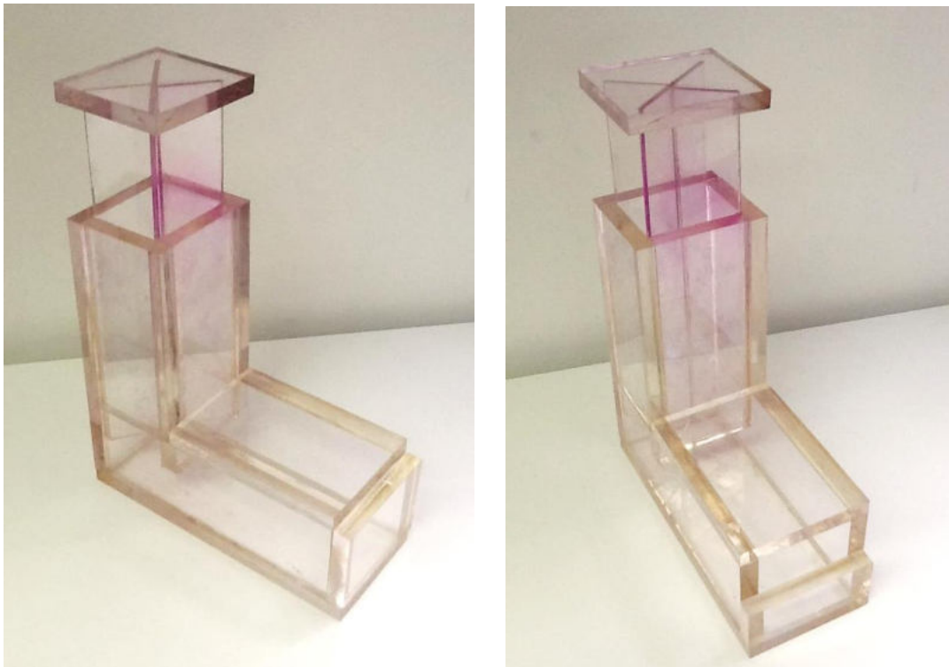
Figures 168 : Maquette d'essai en soufflerie, échelle 1/50
