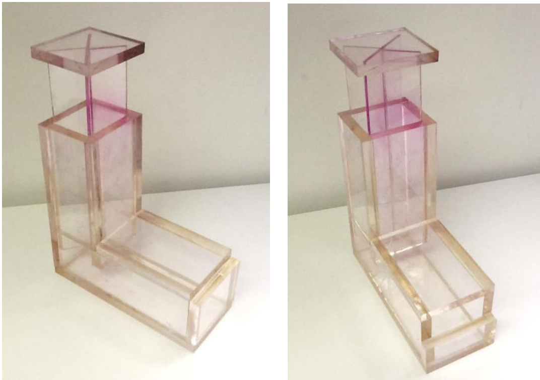
Figures 168 : Maquette d'essai en soufflerie, échelle 1/50
