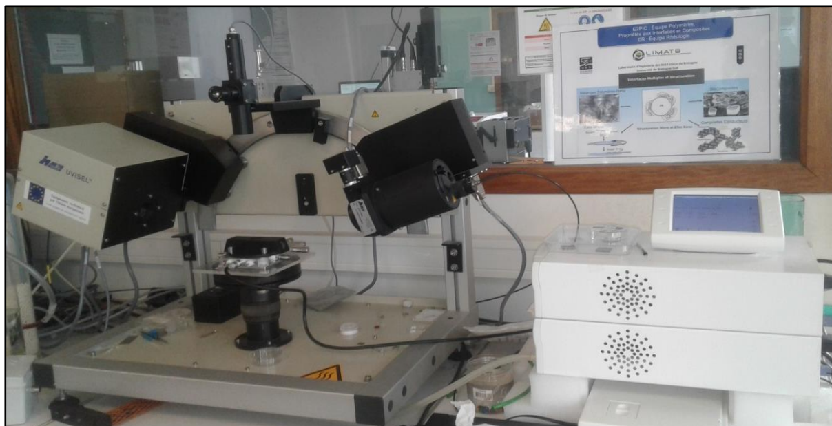
Figure A-10 : Schéma du montage de l'ellipsomètre à modulation de phase et ellipsomètre spectroscopique UVISSEL (Horiba Jobin Yvon) équipé d'une platine de régulation en température
