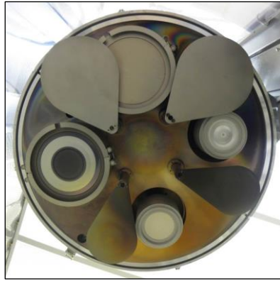
Figure III-21 : Cathodes et cibles sur la platine amovible supérieure
