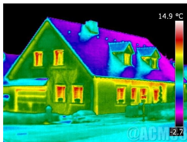
Figure I-6 : Détection des fuites thermiques (en rouge) à l'aide d'une caméra infrarouge
