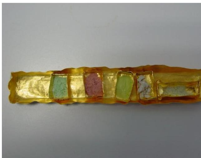
*Figure 4 : Dispositif de fluoration (gauche) et de la nacelle en or avec plusieurs échantillons (droite).*
