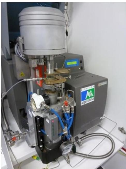
Figure 3 : Analyseur thermogravimétrique sous F<sub>2</sub> développé à l'ICMCB.
