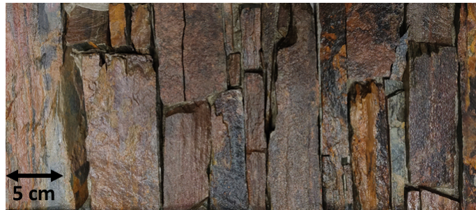
FIGURE 5.19 – Surface rocheuse de quartzite sédimentaire, de forme irrégulière et de forte rugosité
