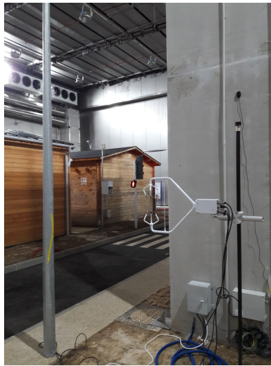
FIGURE 2.10 – Photo de l’anémomètre ultrasonique 3D (capteur CSAT-3B) placé à la position P9 (voir la figure 2.7)
