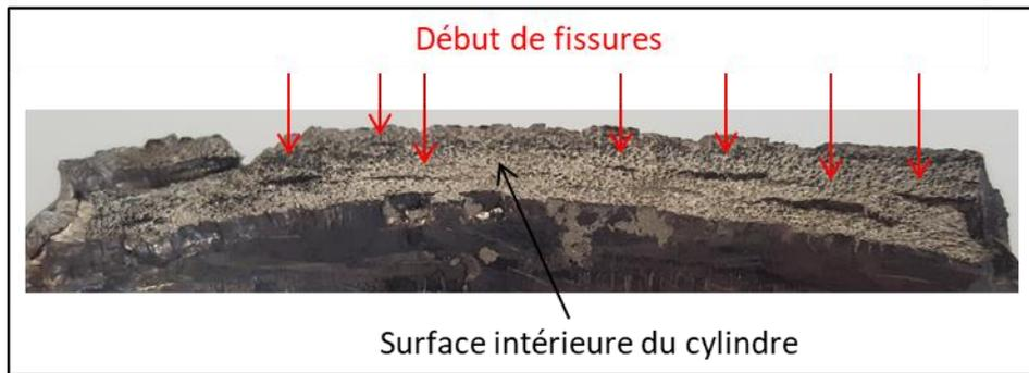
figure (2-41) : Fissures arrêtées sur un éclat de cylindre (Exemple de la surface intérieure)
