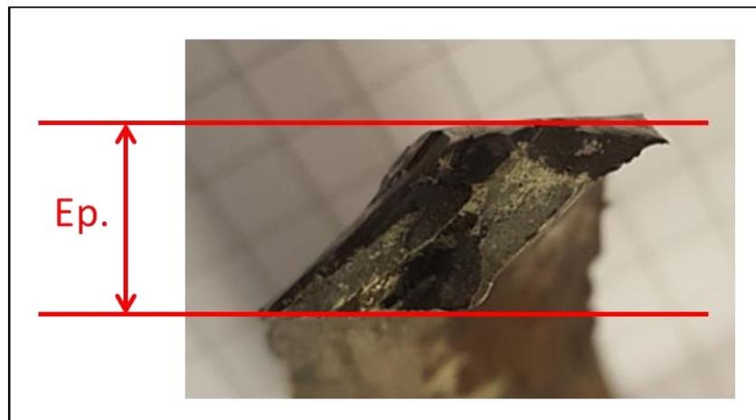
figure (2-42) : Mesure de l'épaisseur
