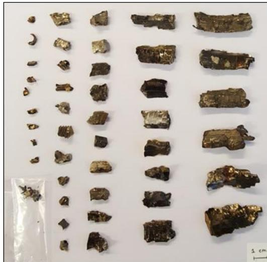
figure (1) : Échantillon de fragments générés par une enveloppe métallique
