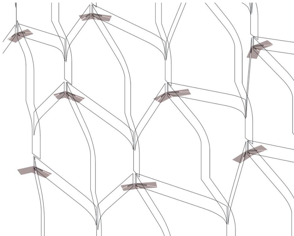
Figure 21. Assemblage des nervures. Un joint horizontal permet de fixer les trois nervures d'un bloc et de bloquer leurs angles. Pour cela un système d'encoche est réalisé sur les nervures et les joints.
