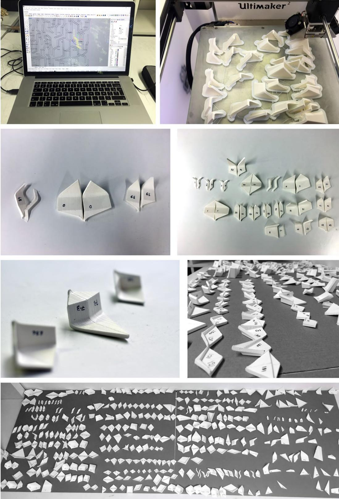
Figure 16. Impression 3D et numérotation des éléments. Chaque élément imprimé correspond à une demi-cellule. Nous avons imprimé au total 738 claveaux.
