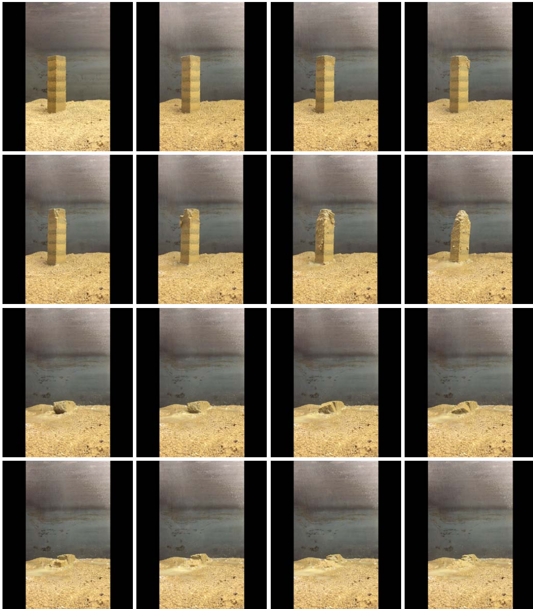
Pisé de terre crue d'Héricy et pluie Vidéo du 21 novembre 2017
