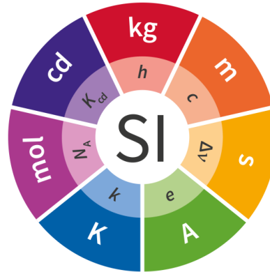
Figure 8 : Unités de base du Système International et les constantes fondamentales associées, Figure tirée de [74].
