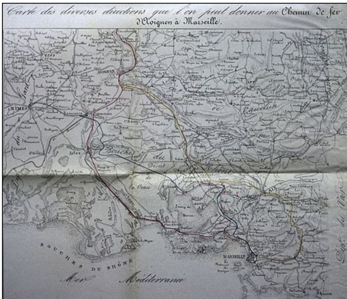
Fig. 202 - Principales directions du chemin de fer d'Avignon à Marseille– (AN) Kermaingant, (par Arles, tracé rouge et par Aix, tracé jaune) Talabot (tracé bleu), Montricher (tracé marron)
