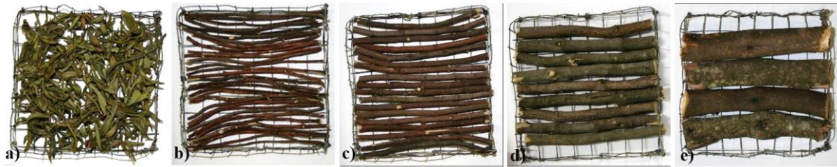
Figure 8 : Exemple de photographies d'échantillons de Ciste de différentes épaisseurs caractéristiques : a) 0,75 mm, b) 2 mm, c) 4 mm, d) 8 mm et e) 15 mm
