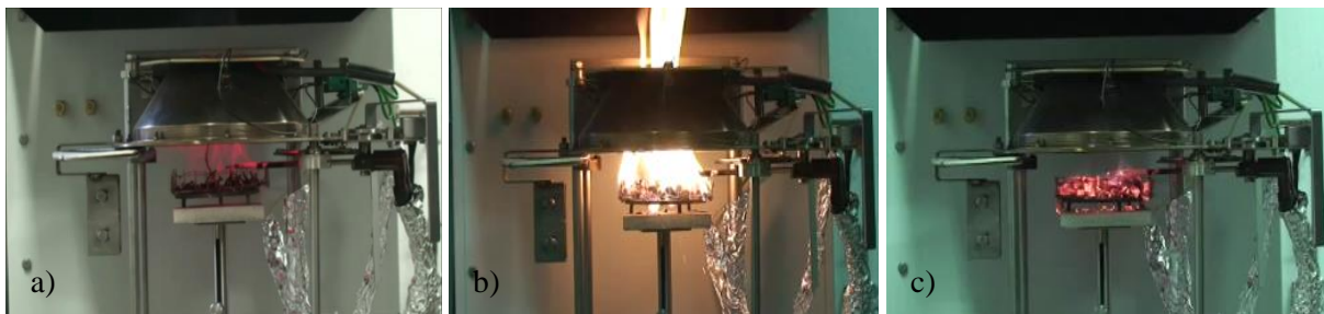
Figure 55 : Photographie de la combustion du ciste de Montpellier. Détermination des trois phases de dégradation : a) pré-ignition, b) combustion avec flamme, c) glowing
