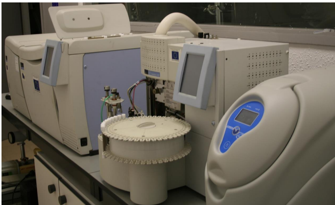
Figure 22 : Chaîne analytique DTA-CPG-DIF/SM
