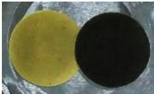
Figure 65 : Photographie des aérosols prélevés sur des filtres durant la phase de pré-ignition (filtre à gauche sur la photo) et durant la phase de flamme (filtre à droite sur la photo)
