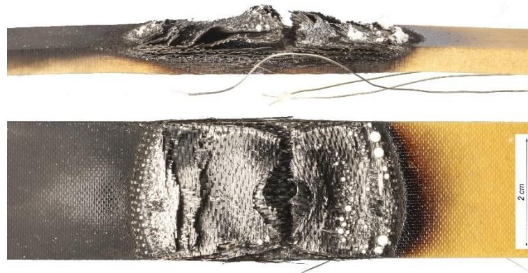
7.1 Photographie d'une éprouvette de traction irradiée ( 191 \text{ W}\cdot\text{cm}^{-2} ; \text{Ø}50 \text{ mm} ; 12,55 s)
