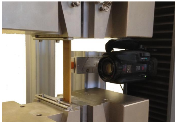
6.8 Vue rapprochée du montage expérimental utilisé lors des essais de traction
