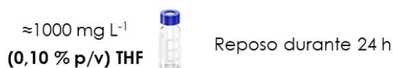
Figura 12. Representación esquemática de la preparación de una solución de 1000 \text{ mg L}^{-1} en THF de asfaltenos y subfracciones A1 y A2, para ser analizadas mediante GPC-ICP HR MS.
