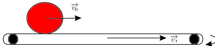
FIGURE 39 : Roulement glissement d'une bille d'acier sur un tapis roulant.
