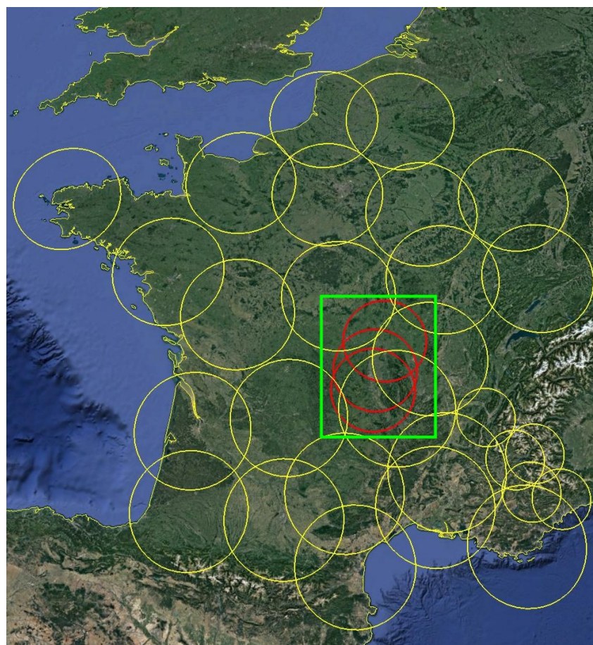
FIGURE 5.6 – En jaune, le réseau des radars PANTHERE. En rouge, le réseau des radars en bande X de Weather Measure. En vert, la portion d’images Panthere correspondant au domaine d’acquisition en bande X.
