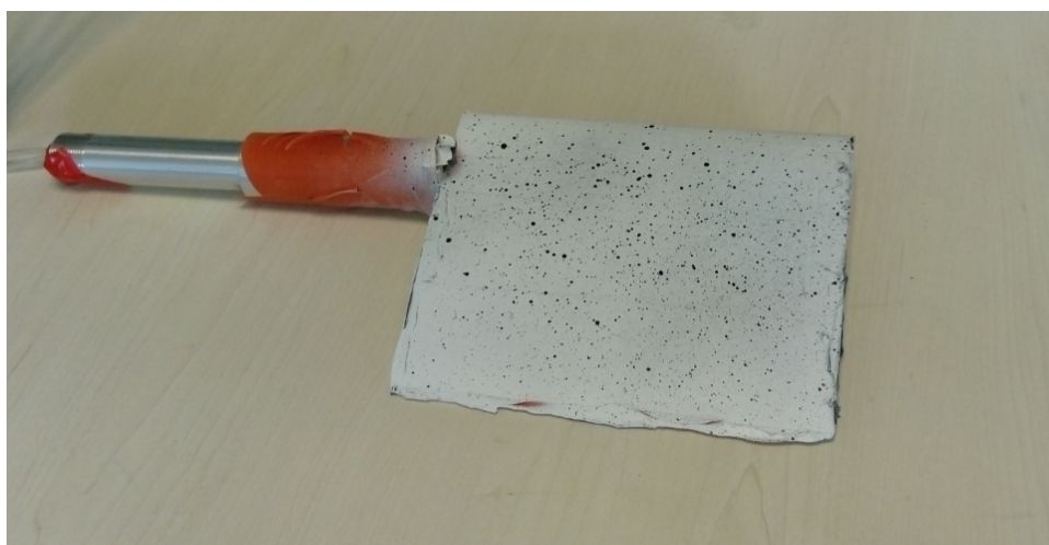
FIGURE 2.13 – Mouchetis réalisé sur l'hydrofoil déformable.
