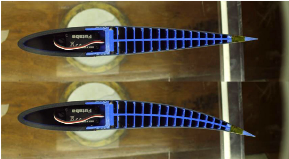
FIGURE 1.3 – Contrôle passif d'un bord de fuite d'un profil aérodynamique, [121].
