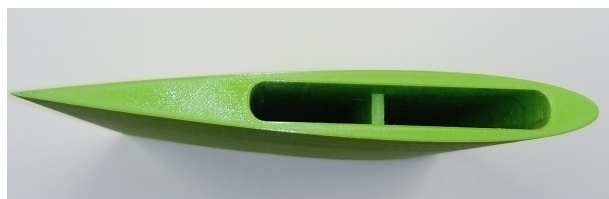
(a). Profil NACA 0012 en impression 3D
