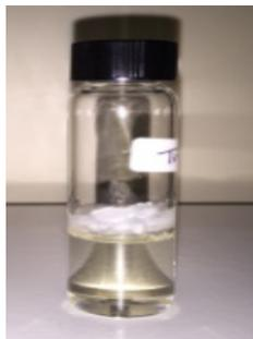
**Figure II. 20: L'isopropoxyde de titane après plusieurs contacts avec l'atmosphère.**
