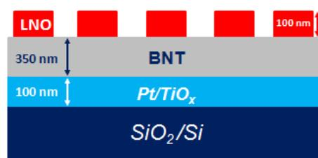
Figure IV. 1: Structure MIM (Métal/Isolant/Métal).
