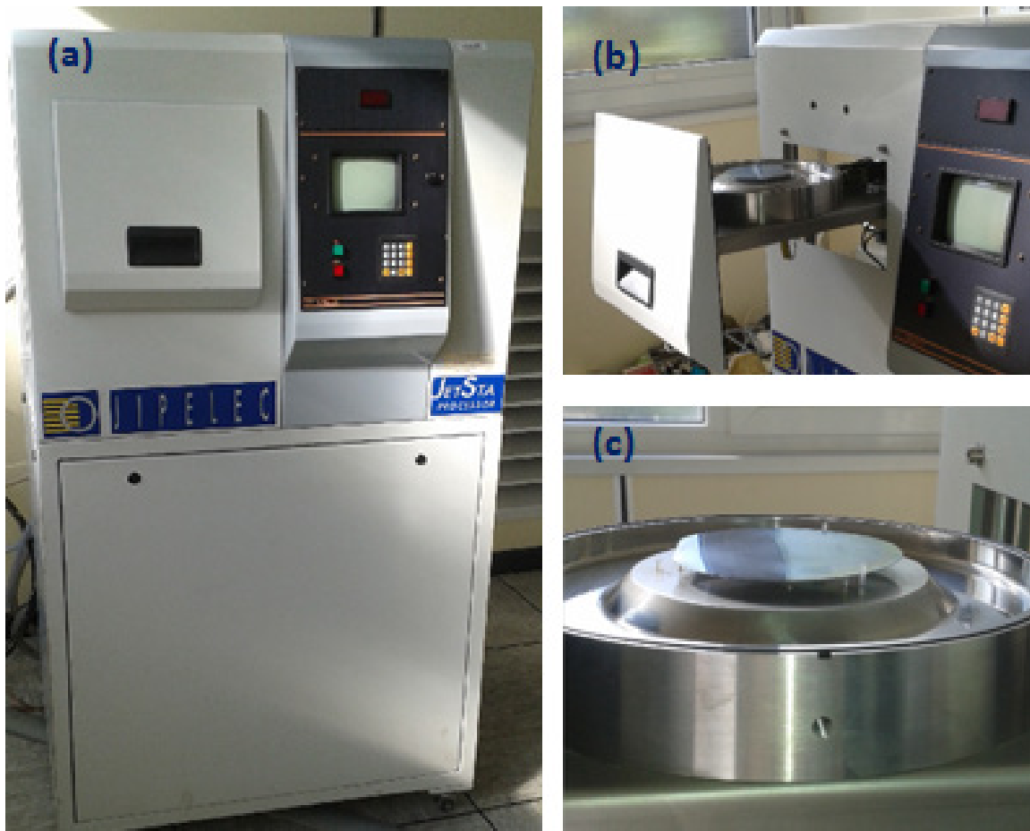
Figure III. 14: (a) Photo de l'ensemble du four à recuit rapide J.I.P.ELEC ; (b) et (c) photos de la chambre du réacteur ouvert.
