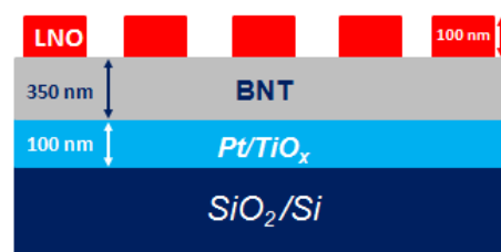
Figure IV. 1: Structure MIM (Métal/Isolant/Métal).
