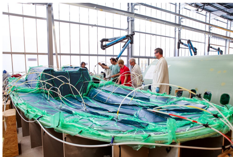
Figure 1-14 : Infusion du pont du voilier monocoque Mini 6.50 d'ARKEMA en 2016 [85]
