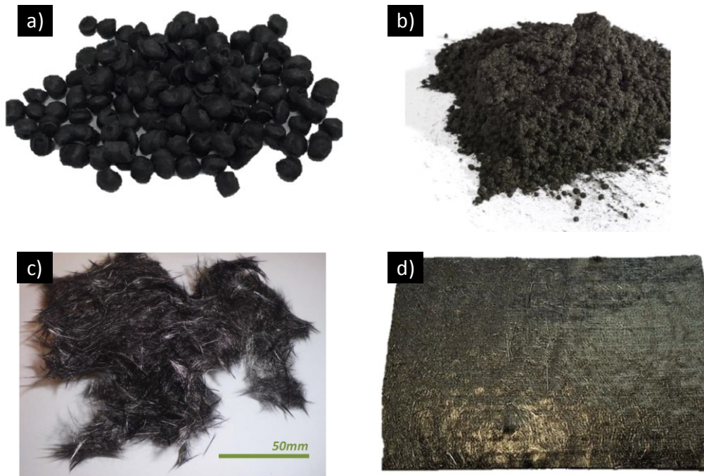
Figure 1-45 : a) Fibres de carbone recyclées par broyage [243], b) Granulés (pellets) fibres de carbone recyclés / matrice thermoplastique [243], c) Fibres de carbonnes recyclées par pyrolyse sur lit fluidisé [262] et d) Non tissé (mat de fibres recyclées) [243]
